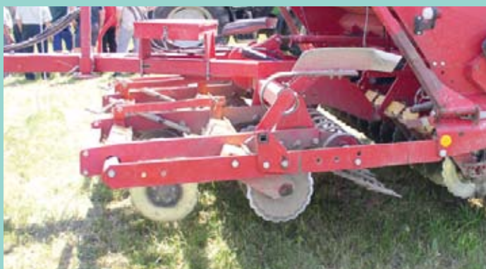
Direktsaatmaschine mit Crossboard zum Freiräumen der Saatschlitz
