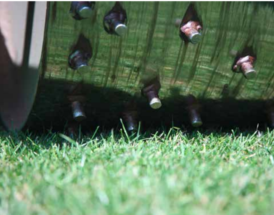
Die Stollenwalze kommt bis zu viermal die Woche zum Einsatz, um die Belastung der Sortenkandidaten zu testen.
